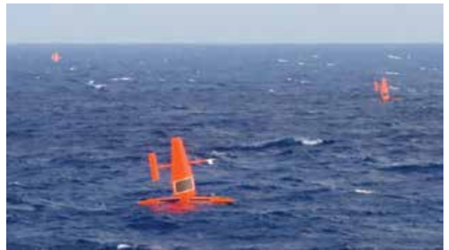
▲ در اینجا با استفاده از پهپادهای دریایی شرکت سیلدرون Sildrone مستقر در کالیفرنیا میزان جذب دی‌اکسید کربن توسط اقیانوس اندازه‌گیری می‌شود
